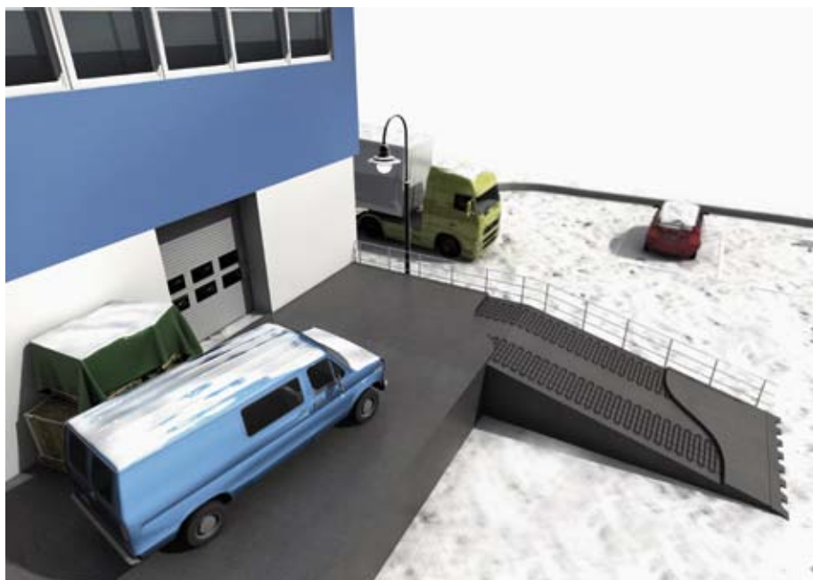
Для легкового транспорта на пандусе можно устанавливать систему антиобледенения только в месте положения колеи (установка в бетон). Необходимо обеспечить беспрепятственный сток талой воды. (Изображение приведено только для общего руководства)
